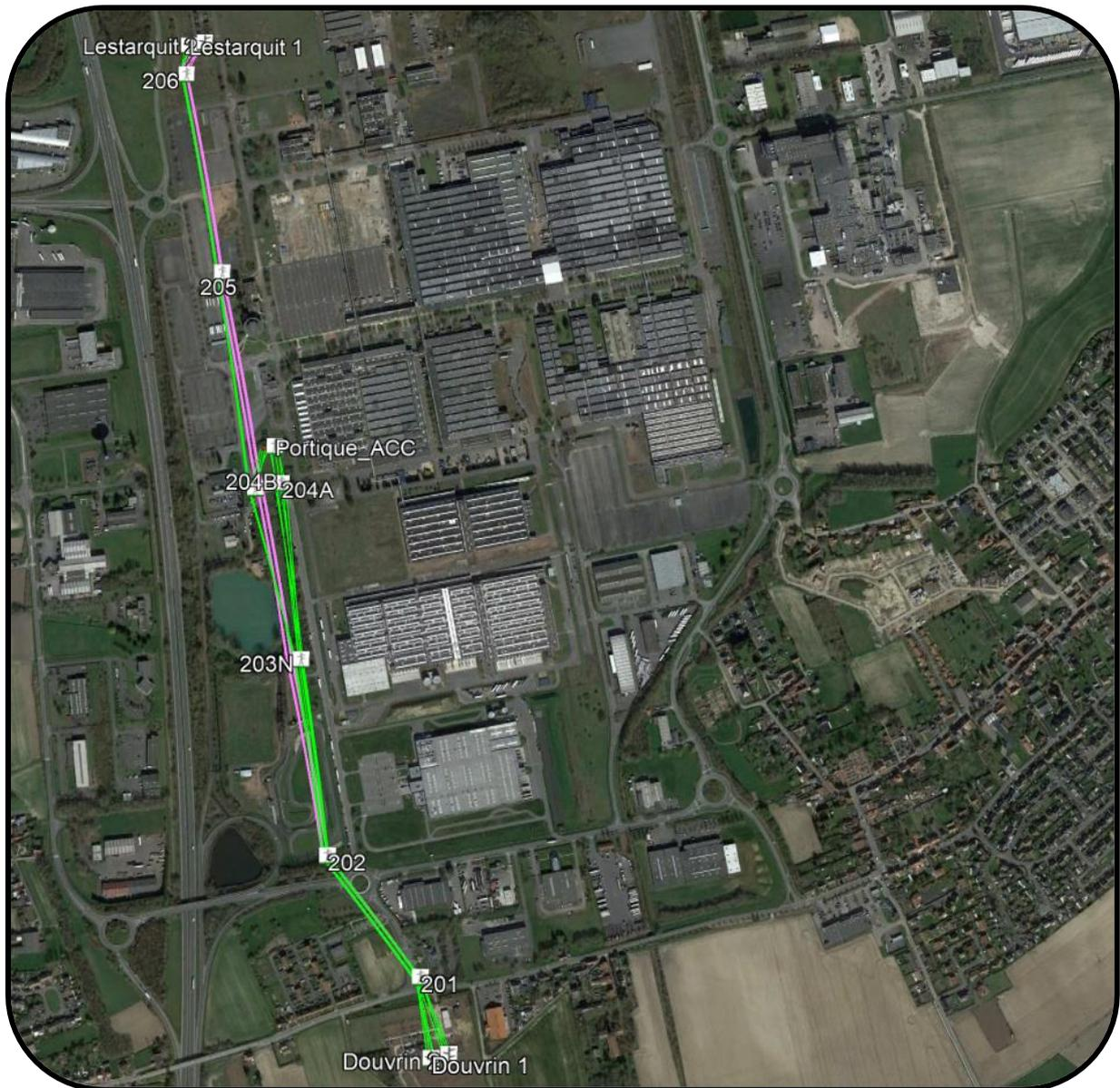
Figure 92. Localisation de la ligne électrique en situation avant travaux (rose) et après travaux (vert)
